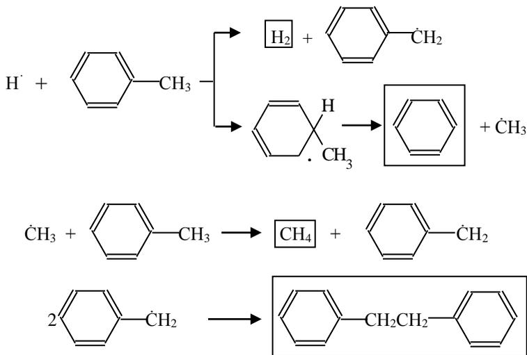
Бензильный радикал ( $\text{C}_6\text{H}_5\dot{\text{C}}\text{H}_2$ ) малоактивен, он вступает главным образом в реакции рекомбинации и цепи не развиваются. Скорость термического распада толуола в этом случае равна скорости разрыва связи  $\text{C}_6\text{H}_5\text{CH}_2\text{-H}$ . Суммарные реакции превращения толуола можно представить как дегидроконденсацию с образованием дибензила и деметилирование до метана и бензола.
